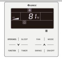
Fig. 4.3 Interface of On status in Fahrenheit
